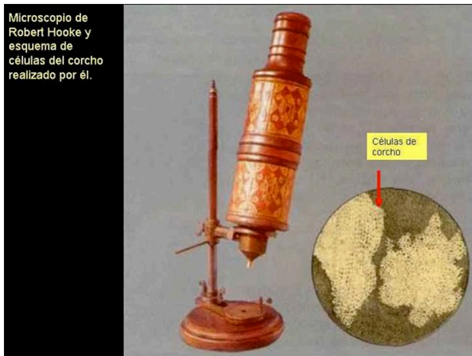
Microscopio usado por Hooke y el dibujo de las “células” del tejido de corcho
