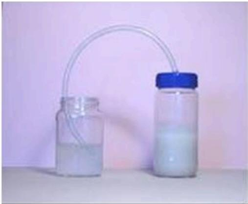
**Epígrafe:** Dispositivo armado para comprobar el proceso de fermentación de las levaduras.
